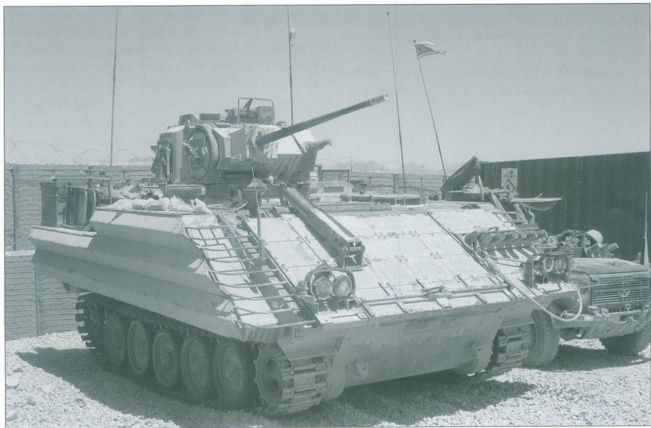
↓ YPR PRI in de thans definitieve uitvoering. Van de bovenste ERA laag zijn de achterste blokken weggelaten om meer bagageruimte te creëren
