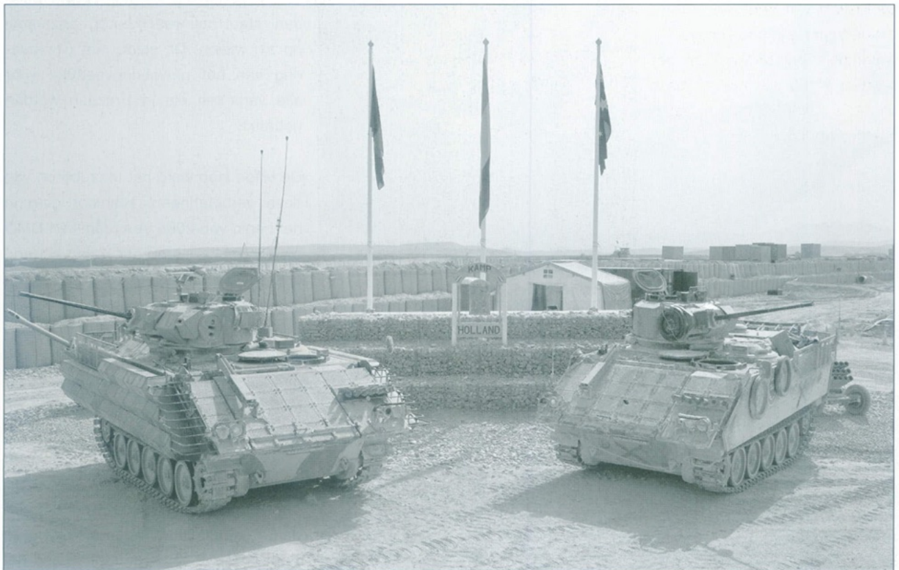
Twee maal YPR765 PRI, links de huidige uitvoering, rechts de "poentjak" variant met alleen de bufferplaten aan de zijwanden (foto: DMO)
