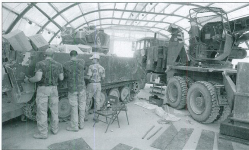
Het monteren van de bufferplaten op de zijwand van een YPR PRI (foto: internet)
